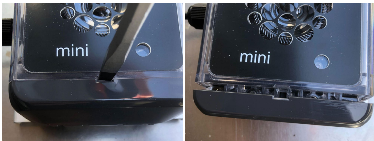
Abb. 1 – Öffnen des Gehäuses
